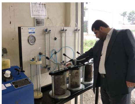
شکل ۱۱: نمونه های استوانه ای تحت آزمایش نفوذپذیری
