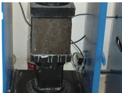
شکل ۹: آزمایش مقاومت فشاری نمونه بتنی نگهداری شده در محیط واقعی
