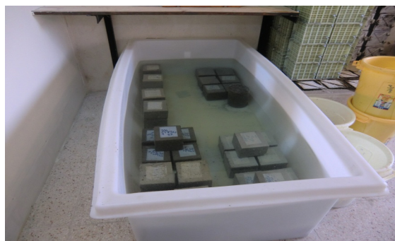
شکل ۵: نحوه نگهداری نمونه های بتنی در محیط آب معمولی
