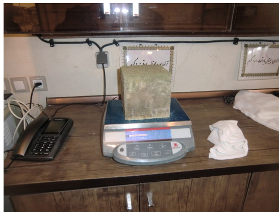
شکل ۱۰: توزین نمونه ها بعد از خشک نمودن در اون
