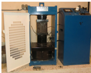
شکل ۷: آزمایش مقاومت فشاری نمونه بتنی نگهداری شده در آب معمولی
