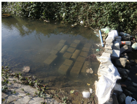
شکل ۶: نحوه نگهداری نمونه های بتنی در محیط واقعی (کانال آبیاری ولکس رشت)
